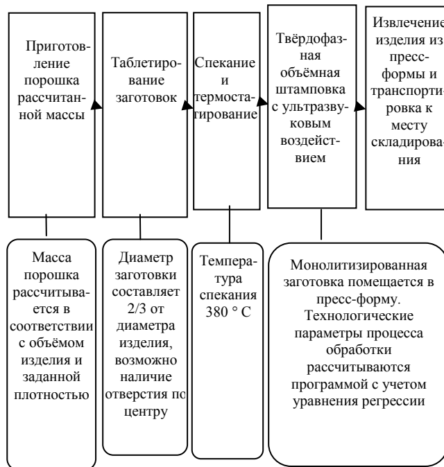
Рис. 2. Разработанная схема технологической линии твёрдофазной объёмной штамповки полимеров с ультразвуковым воздействием.
