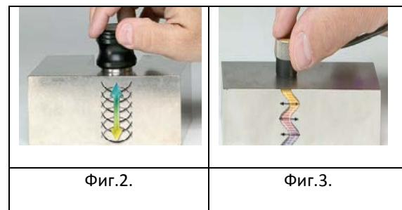
За измерване на величините  $t_{L,T}, \mu\text{s}$  се използва ултразвуково устройство US Key ( ф-ма LECOEUR ELECTRONIQUE, Франция). Точността на измерване на времето на  $t_{L,T}, \mu\text{s}$  е 0.01  $\mu\text{s}$ .
