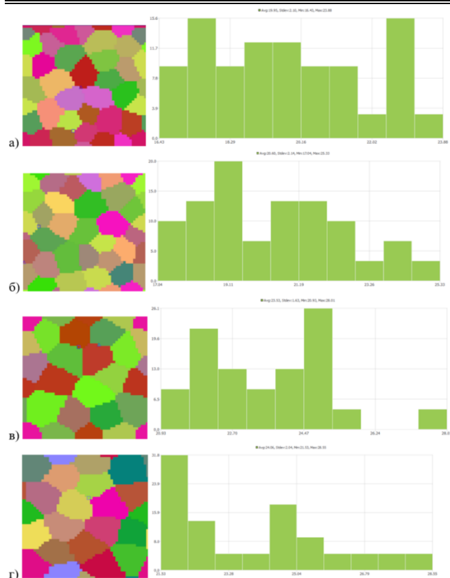
Fig. 8 Микроструктура модели 20-18-16 при 20°C: а – поверхность, поперечное направление; б - поверхность, продольное направление; в – центр, поперечное направление; г - центр, продольное направление
