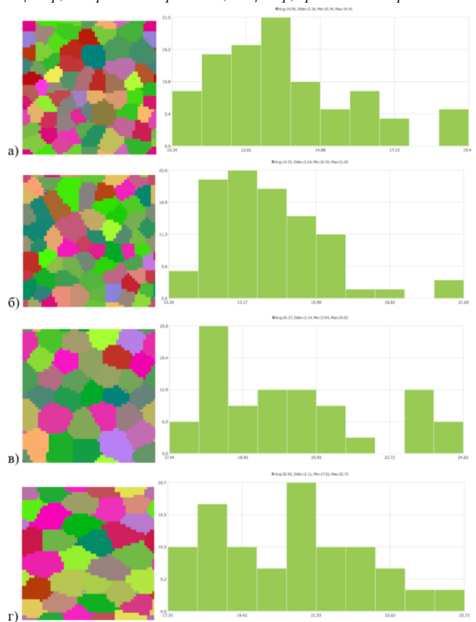
Fig. 4 Микроструктура модели 30-25-20 при 900°C: а – поверхность, поперечное направление; б – поверхность, продольное направление; в – центр, поперечное направление; г – центр, продольное направление
